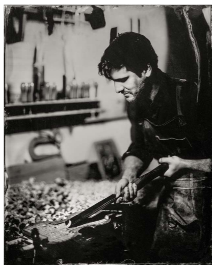
Antoine Carbonare fait l'ébauche du violon à la gouge © Aude Boissaye Studio Cui Cui pour l'INMA
